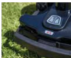
Lökhárító és puha akadályérzékelő Bumper and soft obstacle sensor
